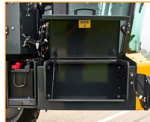
Alloggiamento della batteria scorrevole e ampio vano ridisegnato
