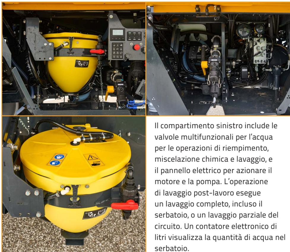
Il compartimento sinistro include le valvole multifunzionali per l'acqua per le operazioni di riempimento, miscelazione chimica e lavaggio, e il pannello elettrico per azionare il motore e la pompa. L'operazione di lavaggio post-lavoro esegue un lavaggio completo, incluso il serbatoio, o un lavaggio parziale del circuito. Un contatore elettronico di litri visualizza la quantità di acqua nel serbatoio.
