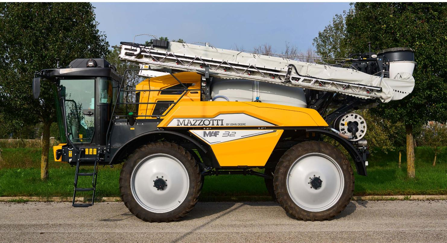
Abbiamo sviluppato un nuovo telaio progettato per ospitare il motore 25 cm più in basso.
