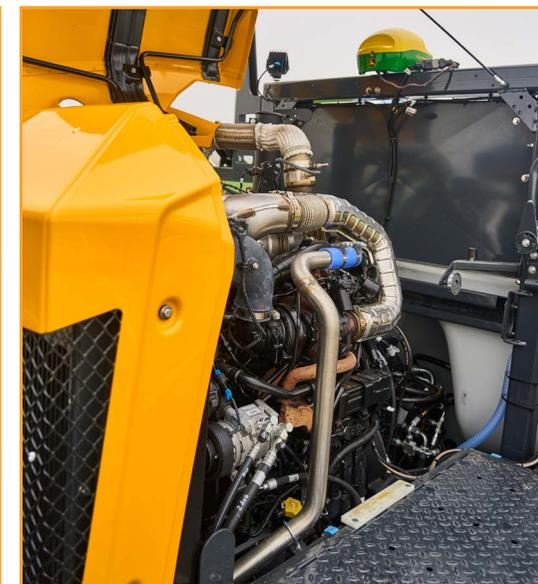
Il motore è contenuto in vani completamente apribili, facilmente accessibili tramite la scala idraulica per la manutenzione. Circuiti di raffreddamento separati per motore, olio idraulico e aria condizionata, per un'efficienza ottimale.
