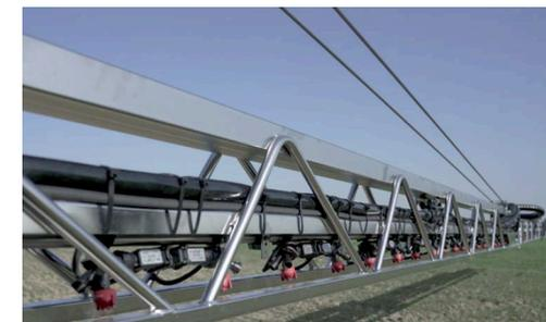
Il MAF può montare due serie di barre: la serie Ti-M e la serie MK. Entrambe le serie sono fornite di serie con controllo dell'ugello singolo. La serie Ti-M può essere equipaggiata sia con il sistema Arag che con il sistema M-Spray, mentre la serie MK è fornita esclusivamente con il sistema M-Spray.
