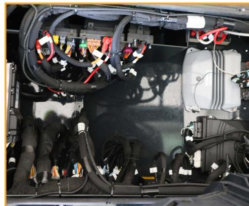
CPU centralizzata con alta protezione di tutti i componenti
