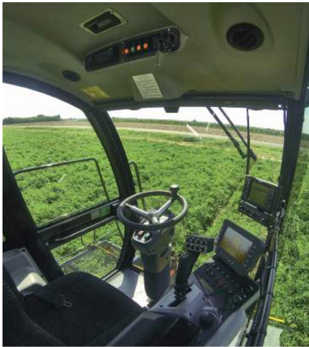
La cabina ofrece de serie un asiento neumático, climatizado y sistema de presurización de nivel 4, con filtros en carbón activo, antipolvo y antivaho.
