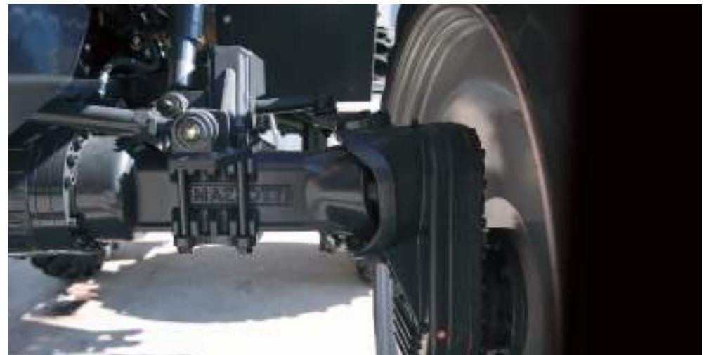
Los diferenciales son un proyecto específico Mazzotti construido por DROMOS. Dos velocidades para el diferencial mecánico y dos velocidades para el motor hidrostático con sistema de autoguía. Trabajar en el barro representa un esfuerzo continuo para la transmisión ya que las ruedas tienden a hundirse sobre terreno mojado. Un trabajo continuo en cuestas de 45% ilustra una situación muy reconocible y complicada.
