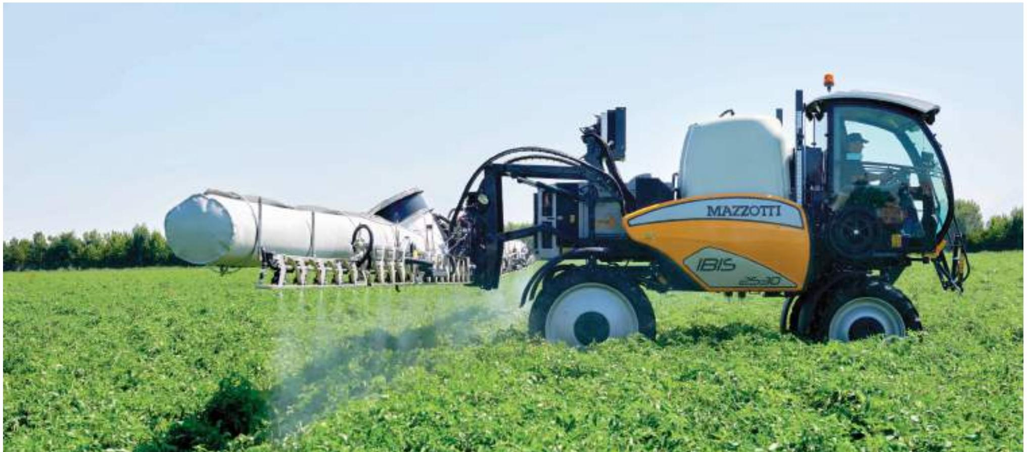
La IBIS M no tiene competidores en estas situaciones. En circunstancias extremas, se pueden bloquear los diferenciales para distribuir la tracción de manera uniforme en las 4 ruedas. Por lo que concierne al desplazamiento por carretera, se puede desactivar la tracción de las ruedas delanteras para consumir menos carburante y neumáticos.
