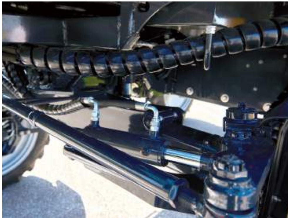
Le réglage de la garde au sol est mécanique, dans les deux modèles. Comme équipement de la cabine pour les deux modèles est prévue également l'ouverture hydraulique simplifiée de la voie, qui en quelques secondes modifie la largeur de la voie du minimum au maximum.
